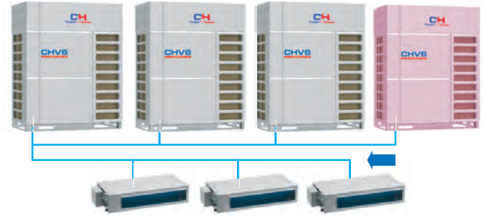
Евакуація холодоагенту у внутрішні блоки
