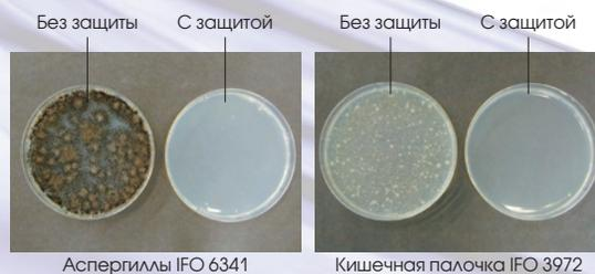
Результаты испытаний, проведенных в исследовательской лаборатории MHI (слева – количество бактерий, помещенных на поверхность вентилятора, справа – количество бактерий через 24 ч).
